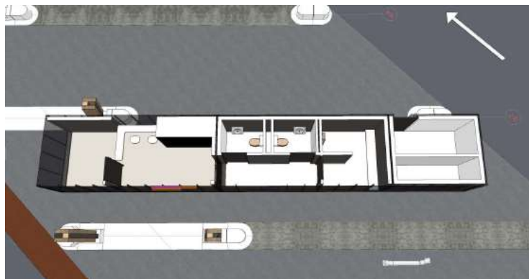
Plantegning for servicebygning i tilknytning til 2 ladestationer
